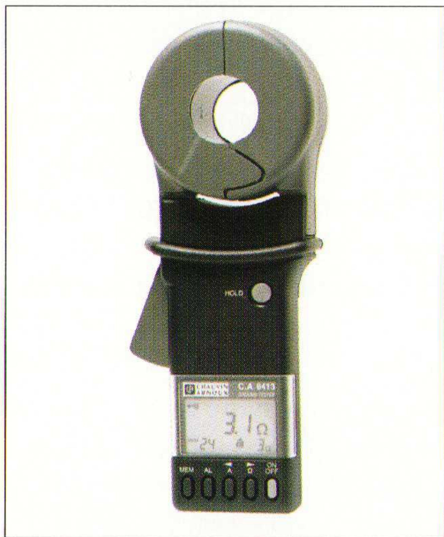
De aardverbindingstester maakt het testen op weerstand eenvoudig.
