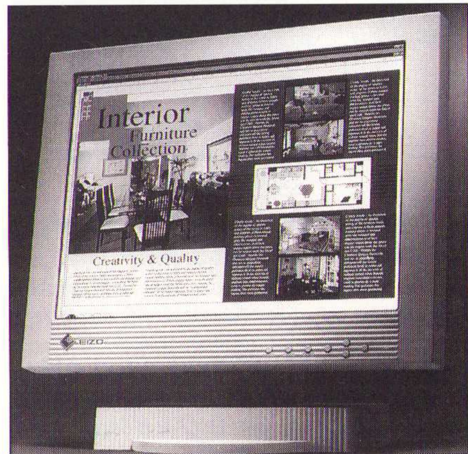
De TFT-LCD die vergelijkbaar is met een 20" beeldscherm.
